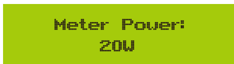
Rys. 7.36 Włączenie funkcji zerowego eksportu przez licznik energii
