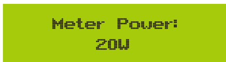
Rys. 7.36 Włączenie funkcji zerowego eksportu przez licznik energii
