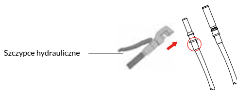
Rys. 3.4 Zaciskanie styku do przewodu
