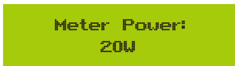
Rys. 7.36 Włączenie funkcji zerowego eksportu przez licznik energii
